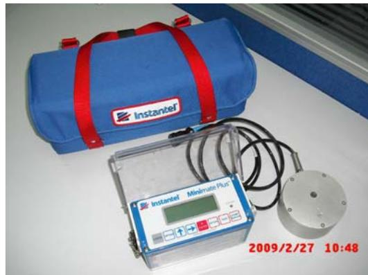
图 3 InstanTel MiniMate Plus 振动监测仪主机+ISEE 型速度传感器
